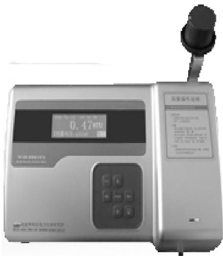
Анализатор кремния лабораторный НК-218W предназначен для контроля качества воды электростанций.
