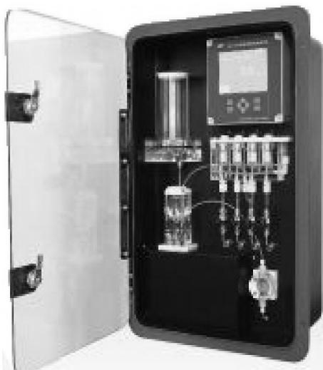
Анализатор фосфатов НК-108W предназначен для контроля качества котловой воды электростанций.
