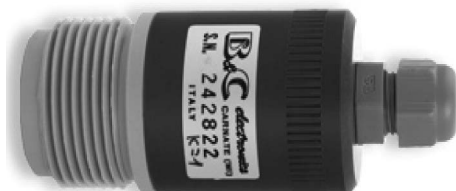
Датчик SI 3013 Корпус PP, электрод SS 316 K=1 ; T<50^{\circ}\text{C} ; P_{\text{max}}=3 \text{ bar} при 20^{\circ}\text{C} ; гермоввод; монтаж 1'' \text{ BSP} Датчик температуры RTD Pt100
