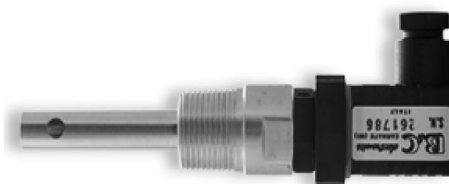
Датчик SZ3330.1 . Корпус SS316, PEEK, электрод SS316 K=1 ; T<100^{\circ}\text{C} ; P_{\text{max}}=16 \text{ bar} при 25^{\circ}\text{C} ; быстросъемный разъём; Монтаж: 3/4'' \text{ MNPT} , L 55 \text{ mm} Датчик температуры RTD Pt100
