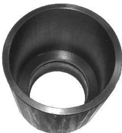
Рисунок А.8 — Калибровочная ячейка для поверки и регулировки погружаемых датчиков
