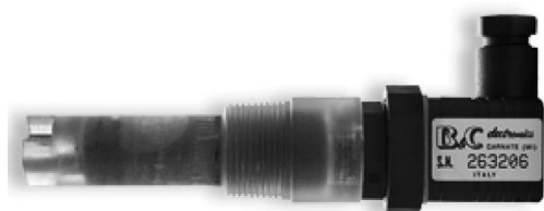
Датчик SZ3300.1 . Корпус PES, графитовый электрод K=1 ; T<130^{\circ}\text{C} ; P_{\text{max}}=10 \text{ bar} при 20^{\circ}\text{C} ; быстросъемный разъём; Монтаж: 3/4'' \text{ MNPT} , L 55 \text{ mm} Датчик температуры RTD Pt100
