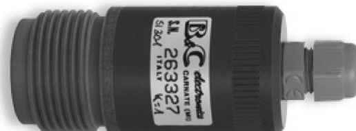
Датчик SI 301 Корпус PVC, электрод SS 316 K=1 ; T<40^{\circ}\text{C} ; P_{\text{max}}=3 \text{ bar} при 20^{\circ}\text{C} ; гермоввод; монтаж 1'' \text{ BSP} Датчик температуры RTD Pt100
