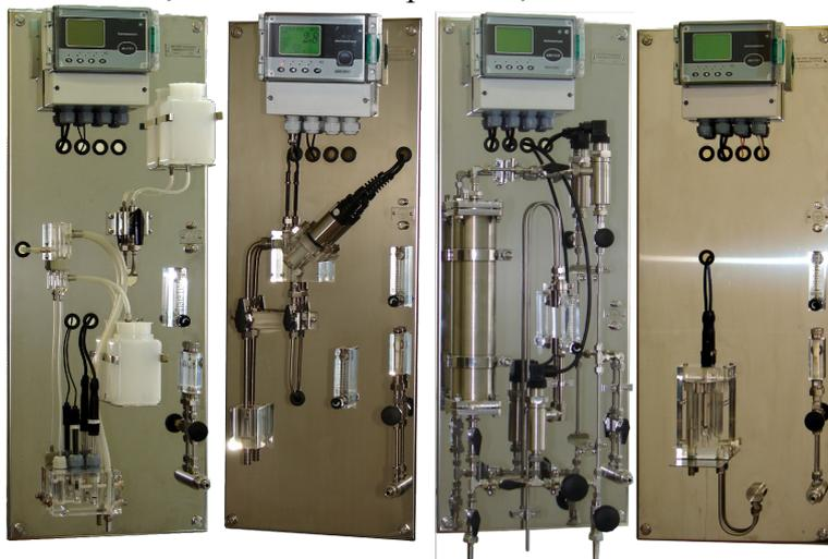
Рисунок 1 Гидропанели анализаторов
